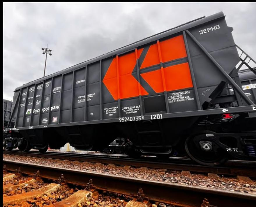
Основные виды закрытых вагонов-хoppers – зерновоз, минераловоз и цементовоз. Все модели отличаются друг от друга способом выгрузки грузов и методом управления разгрузочными люками – механическим (пневматическим) или ручным. Разгрузка может происходить как на само полотно (в межрельсовое пространство), так и в сторону от него – по внешним сторонам вагона.
